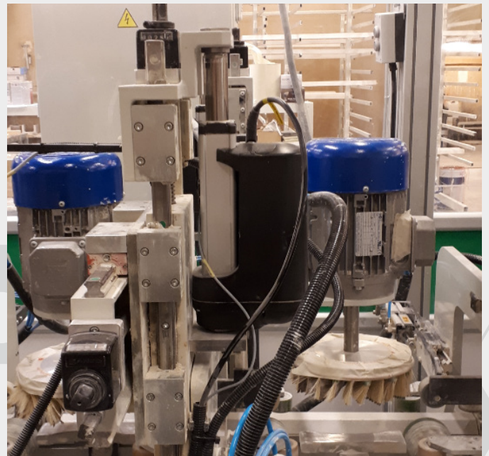
Retrofittet el-aktuator, som er anvendt i løsningen, ses i midten af billedet.
